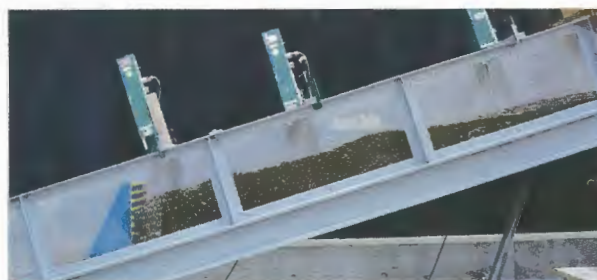
水理模型実験による土石流捕捉機能の確認(HBBO + 型)
