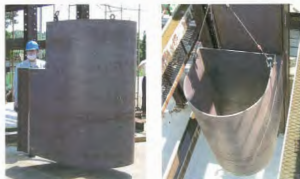
ジョイントスペーサー試作による嵌合継手の検証
