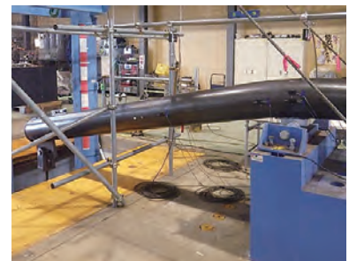
実験状況 (LST部材曲げ実験)
