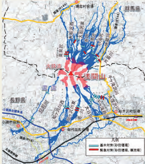
図-4 融雪型火山泥流の被害想定範囲と対策計画図(火砕流 27万m 3 ・積雪深0.5m)
