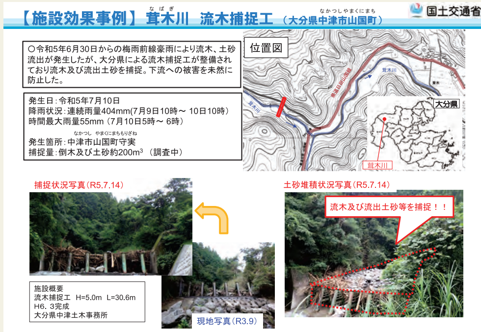
図-4 大分県 茸木川 流木捕捉工
