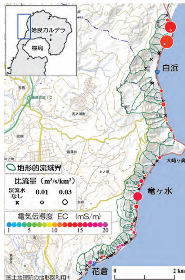
図-10 始良カルデラ西壁における地下水型崩壊危険渓流の抽出
