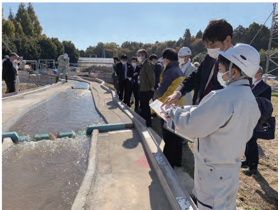
水理模型実験で遊砂地の施設効果を検討している様子。コミュニケーションは未だに苦手意識がありますが、社外の方とお話することで、自分の理解度や自分たちの立場を知ることができました。発注者や協力会社と良い関係を築き、お互いに協力することで、良い成果を作り上げていくことができることも学びました。(写真右手前筆者)
