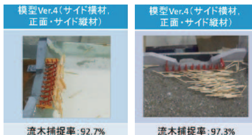
水理模型実験による流木捕捉機能 (左: 未満砂、右: 満砂)
