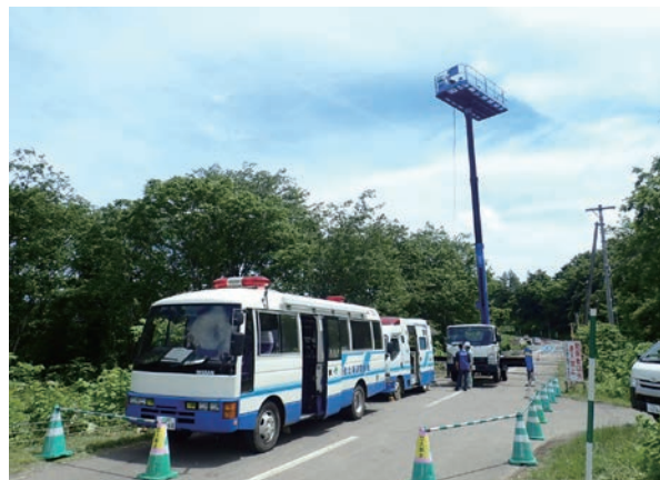
写真-2 移動基地局および高所作業車 （提供：日本工営株式会社 早川智也氏）
