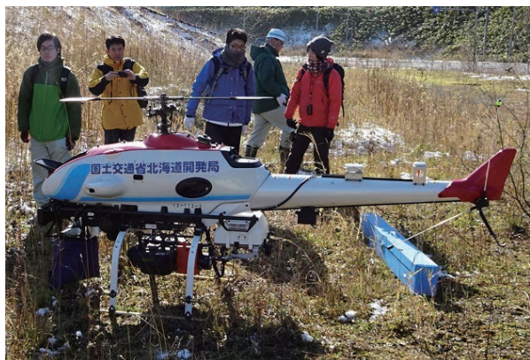
写真-1 無人ヘリコプター（ヤマハ自律航行型無人ヘリコプター RMAXG1）。機体の下側にレーザースキャナー、尾にGPSアンテナを搭載
