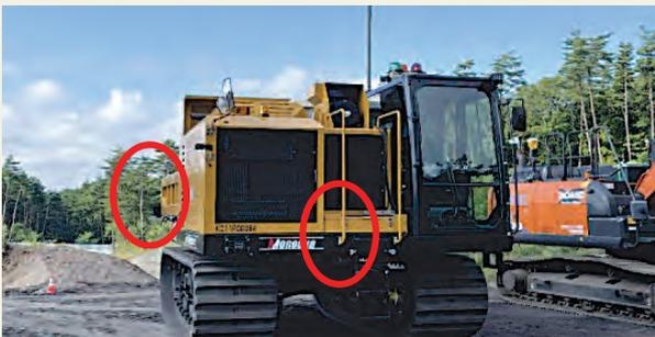
図-13 カメラ設置状況(キャリアダンプ)
