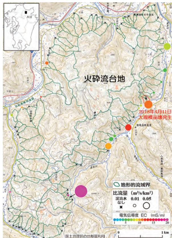
図-8 耶馬溪町の火砕流台地周縁における地下水型崩壊危険渓流の抽出
