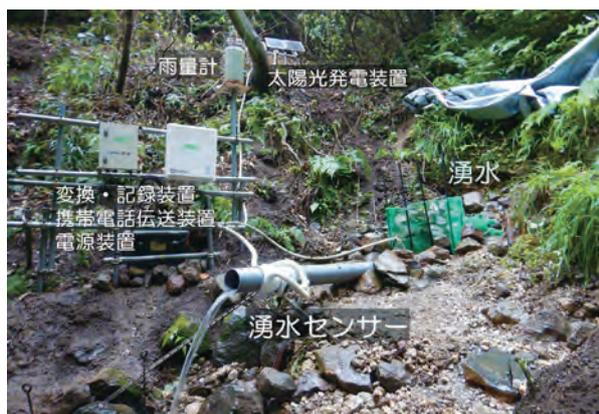
図-13 始良カルデラ壁に設置した湧水センサー
