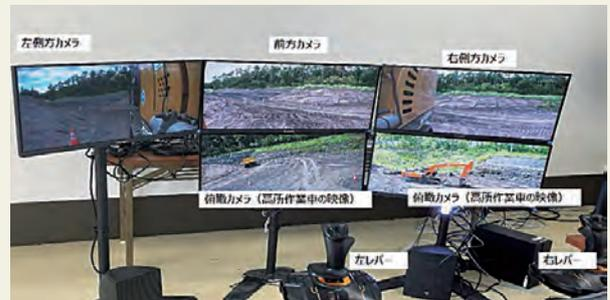
図-11 キャリアダンプ操作席
