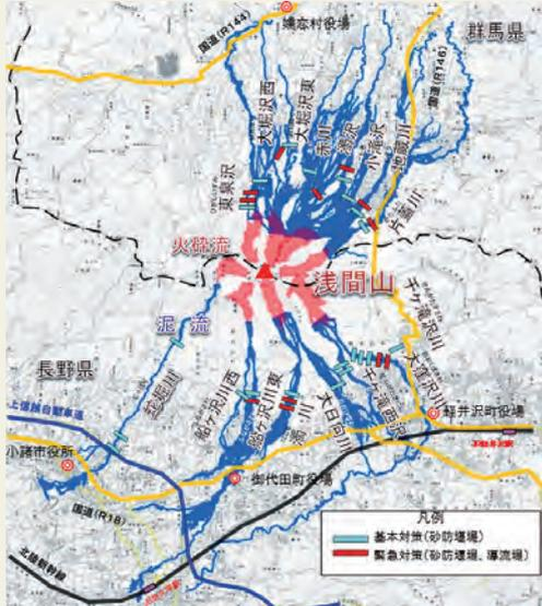
図-4 融雪型火山泥流の被害想定範囲と対策計画図(火砕流27万m<sup>3</sup>・積雪深0.5m)
