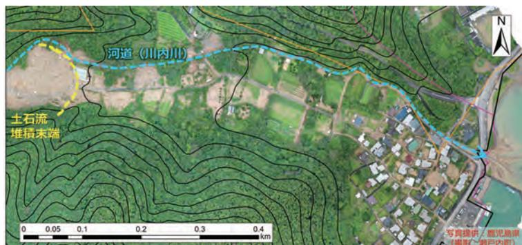
図-10 集落付近の被害状況等
