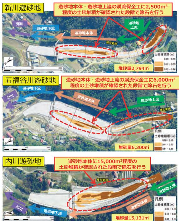
図-5 1/10年規模の出水後の堆砂状況
