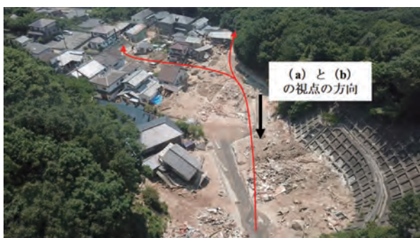
(c) 宅地内の土石流の流動経路
