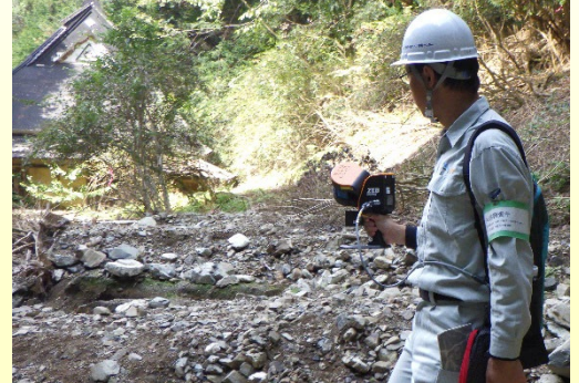
DX技術を活用した災害現場の計測 (ハンディLiDARスキャナ)
