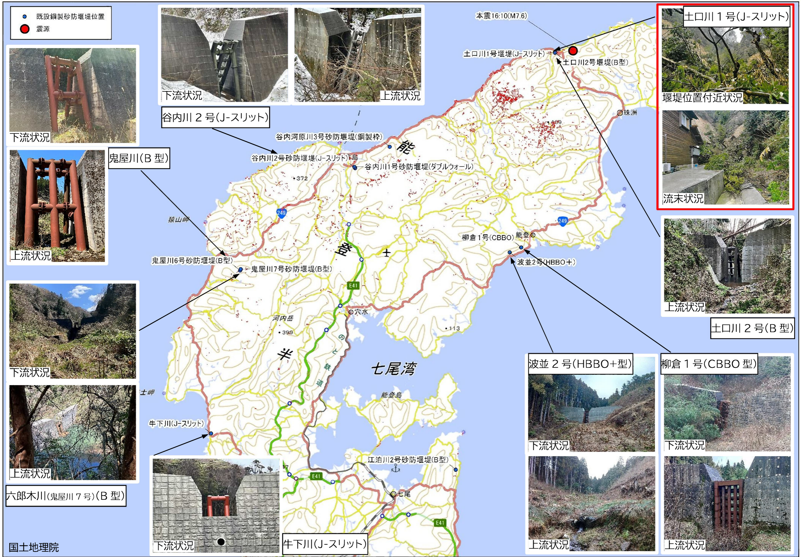
図 鋼製透過型砂防堰堤 位置図及び状況写真
